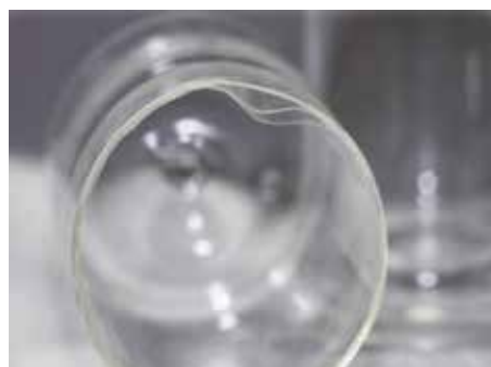
Dreischichtiger Aufbau eines COP-Zylinders: COP – Polyamid – COP. (Abb.: ZlnstSanBw)
