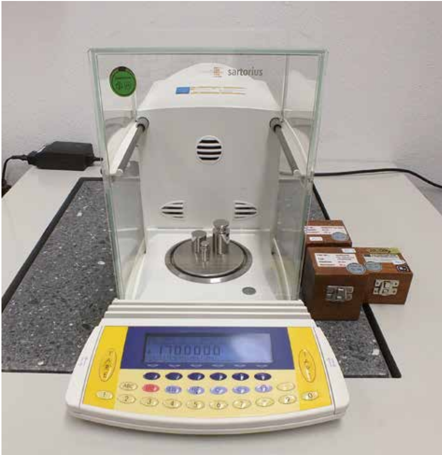
Überprüfung einer Analysenwaage mittels Prüfgewichten.
