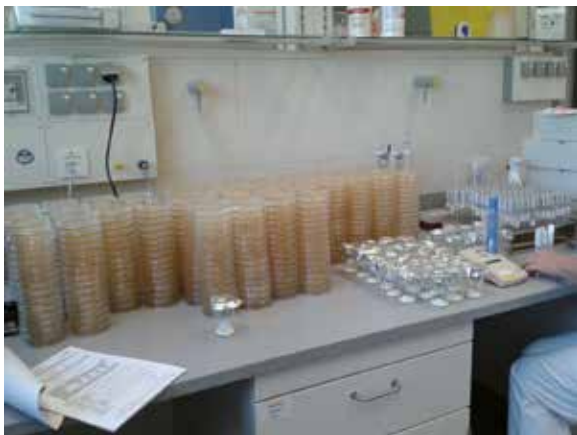
Abb. 4: Konservierungsbelastungstest. Die Prüfung auf ausreichende antimikrobielle Konservierung von Arzneimitteln erfolgt mit hohem materiellem und personellem Aufwand.
